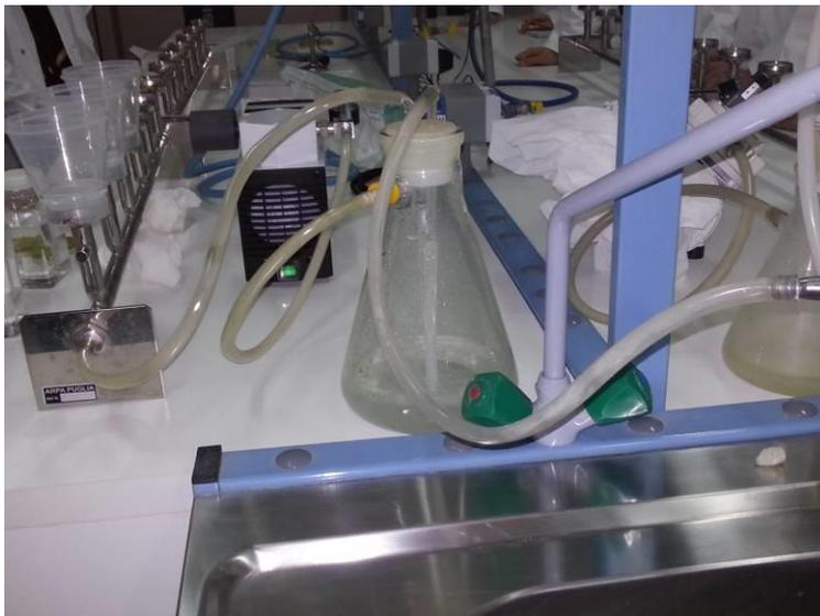
Ed abbiamo attivato la pompa di filtraggio (fig. 8)
